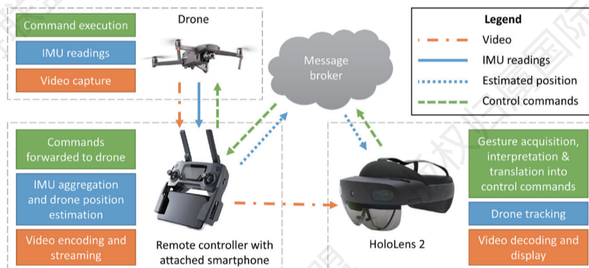
图 6-11 结合无人机、混合现实头盔和卫星定位系统的智能追踪系统
